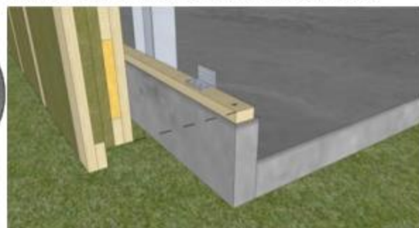
Figure 12 - Panneau PANOBLOC® en approche de la lisse basse bois massif
