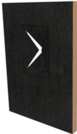
Figure 46 – Mise en place du pare pluie et découpe en croix
