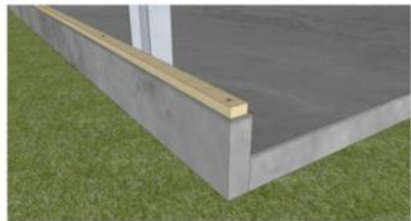
Figure 10 - Mise en œuvre de la lisse basse bois massif
