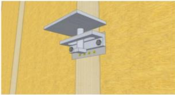
Figure 25 – Insertion du plat intermédiaire et verrouillage par ¼ de tour
