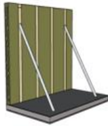
Figure 31 – Etaisement du mur inférieur
