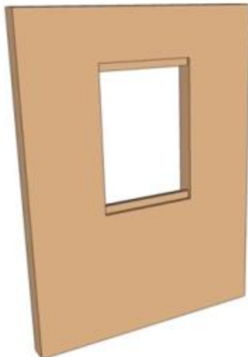
Figure 40 – Usinage de l'ouverture et de sa périphérie
