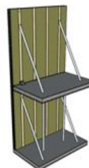
Figure 38 – Pose du panneau supérieur, ancrage à la ferrure, étaisement du mur et suppression du garde-corps
