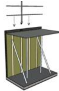
Figure 32 – Pose du garde-corps et du fond coffrage supérieur
